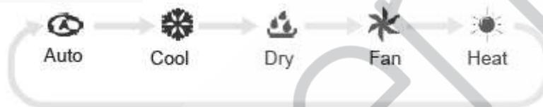
Wenn der AUTO-Modus ausgewählt ist, arbeitet die Klimaanlage gemäß den Werkseinstellungen. Die Temperatur kann nicht wie gewohnt auf dem Display eingestellt werden.
