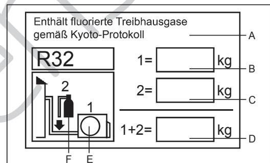
Dieses Produkt enthält fluoriierte Treibhausgase gemäß Kyoto-Protokoll. Nicht in die Atmosphäre entweichen lassen. Kältemitteltyp: R32
