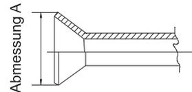
Wird an Geräten mit R32 ein Bördelwerkzeug des Kuppeltyps verwendet, sollte der überstehende Teil des Rohrs zwischen 1,0 und 1,5 mm groß sein. Ein Kupferrohr-Messgerät zum Einstellen des Überstands ist von Vorteil.
